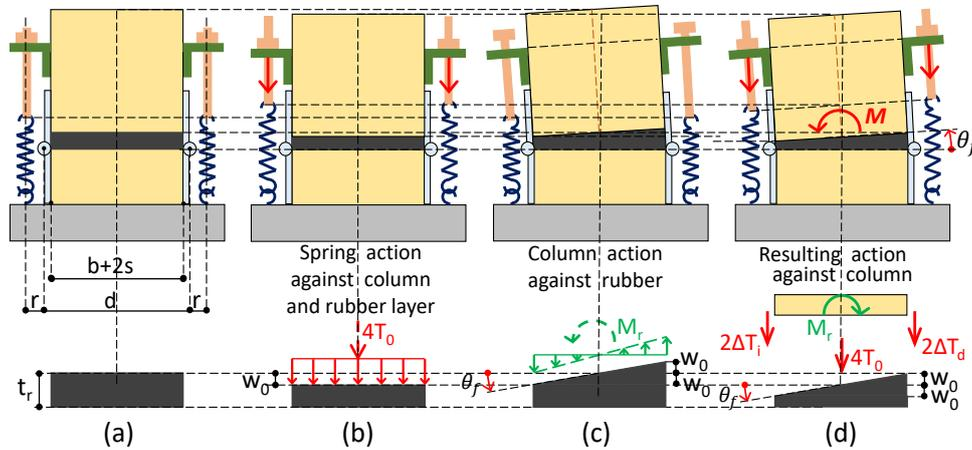
**Figure 2.** Initial elastic branch deformation. (a) Without deformation ( $b=100\text{mm}$ ,  $s=12\text{mm}$ ,  $d=132\text{mm}$ ,  $r=6\text{mm}$ ,  $t_r=4\text{mm}$ ); (b) Post-tension load; (c) no tension + yield rotation; (d) Yield point.
